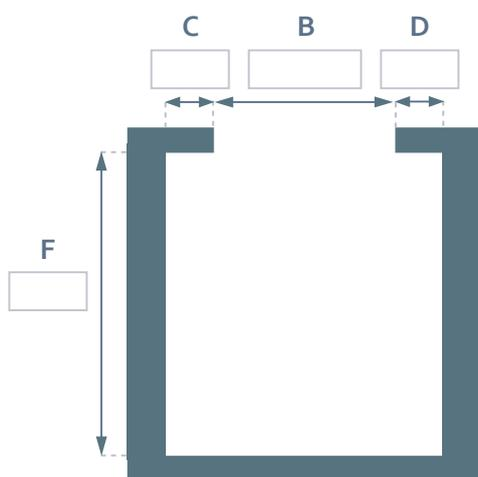
La profondeur du mur de refoulement (F) doit être supérieure ou égale à la largeur baie (B) - 600 mm
