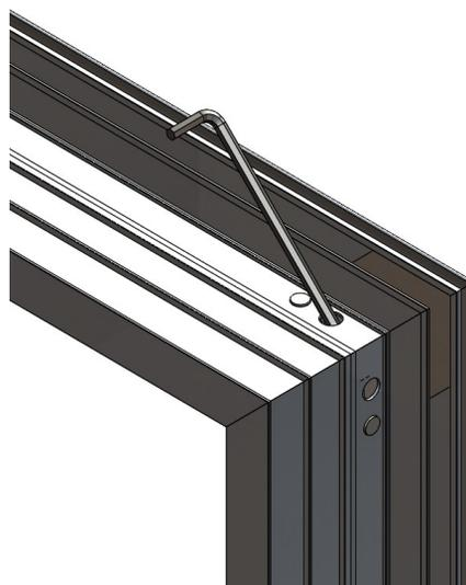
Serrez alors vos assemblages à l'aide d'une clef 6 pans. Idéalement, préférez une clef à embout arrondi.
