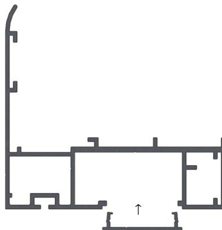
Pareclosez alors vos dormants. En premier, la pareclose haute. Attention au sens des parecloses latérales, pointe basse vers l'extérieur. Afin de garantir un bon fonctionnement et une souplesse constante du joint, celui ci doit être graissé régulièrement avec une graisse solide à base de silicone.
