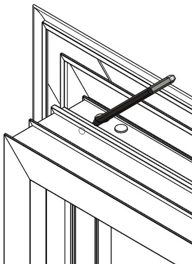
Assembler la traverse aux deux montants. Travailler à plat pour plus de confort.
