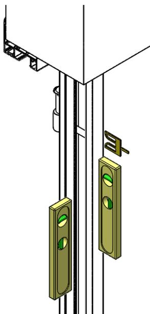
Caler le bâti à l'aide des cales fourchettes fournies si besoin en vérifiant les niveaux dans les deux sens. S'assurer d'avoir les diagonales identiques.
