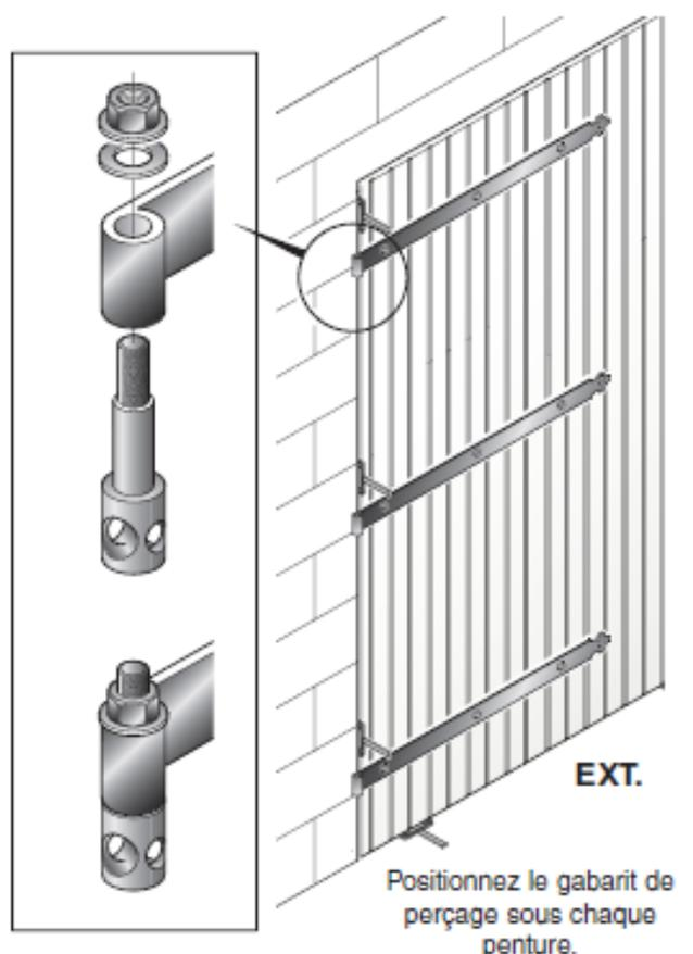
1 - Percez à l'aide d'un forêt de Ø 16 béton pour des gonds à scellement chimique.
