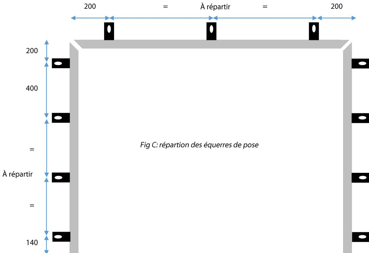
Fig C: répartition des équerres de pose
