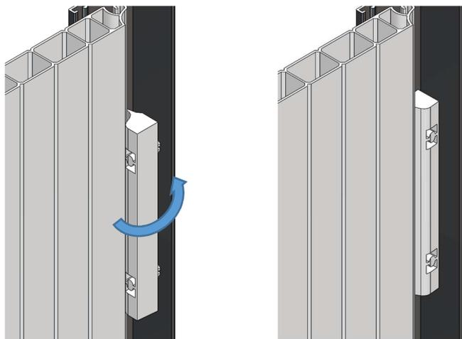
Engager les renforts de chaque côté puis les clipper dans les trous des montants. Au besoin et selon vos réglages, vous serez peut-être amené à repercer des trous supplémentaires.
