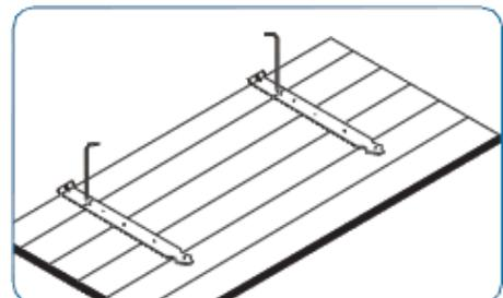
3) Enfiler les neusillons sur les éléments feston rainurés en les alignant en fonction du déport souhaité et serrer modérément les vis pointeaux\*
