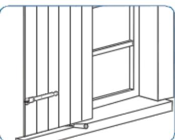
4) Présenter le volet dans son emplacement en respectant les jeux périphériques. Si nécessaire, dévisser les vis pointeau pour ajuster le déport
