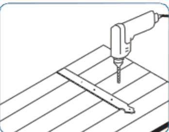
1) Si nécessaire, couper les éléments feston rainurés à dimension souhaitée et les fixer, rainure contre le volet
