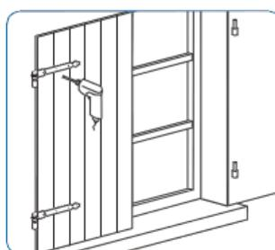
6) A l'endroit du trou du neusillon, percer l'élément feston rainuré et la première toile du volet et fixer\*\*
