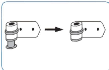
2) Monter la douille avec l'écrou de réglage dans l'œil de chacun des neusillon et visser en laissant quelques mm de jeu
